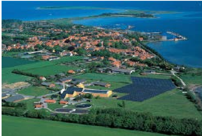
Ærøskøbing 4 900 m 2 / 3,4 MW kombiniert mit Stroh-Kessel
